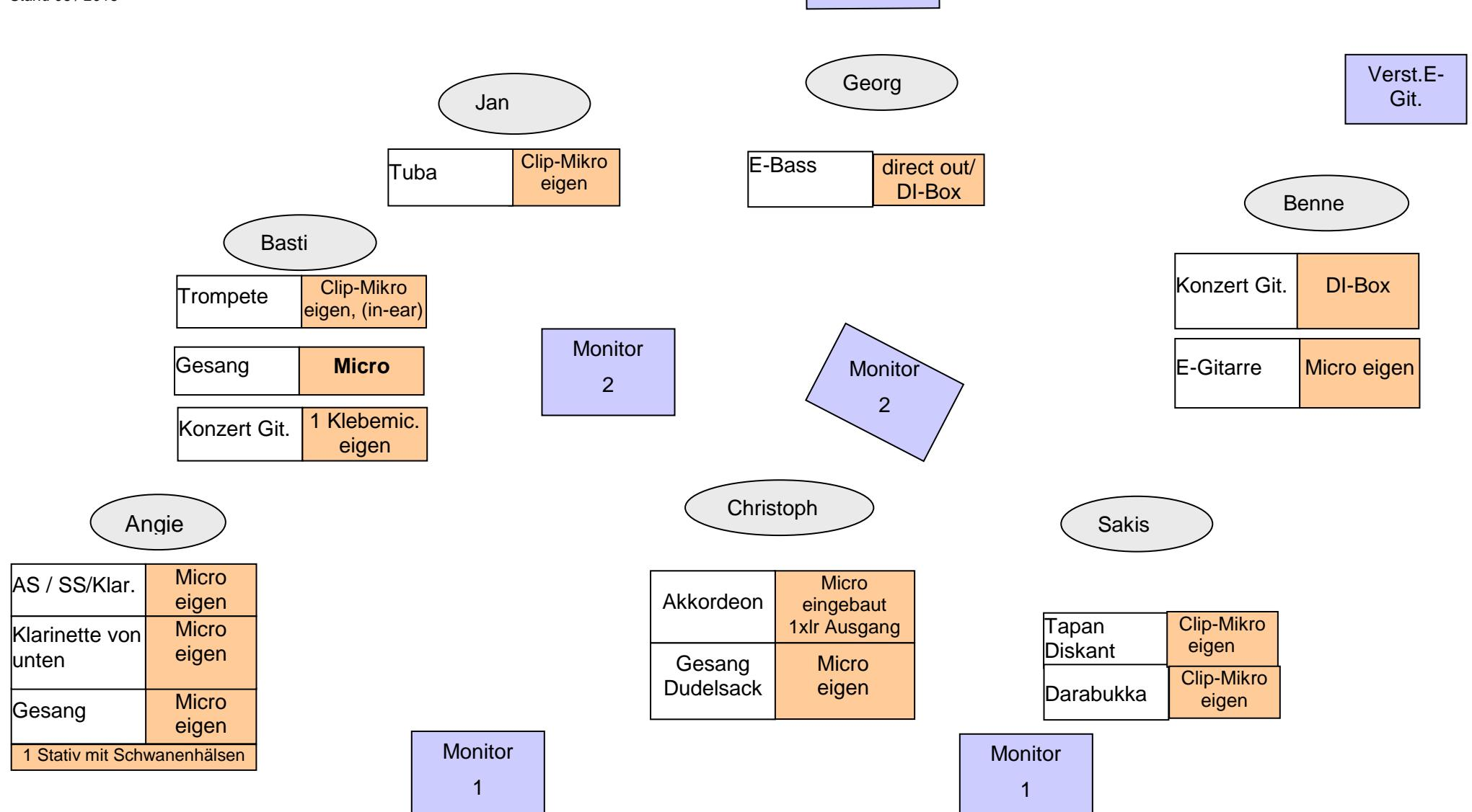
14 Kanäle Multicore; alle Mics XLR, - vermerkte Mikros (eigen) bringen wir mit. – 3 bis 4 Monitore auf 2 Wegen und 1 x 230 V für Verstärker
